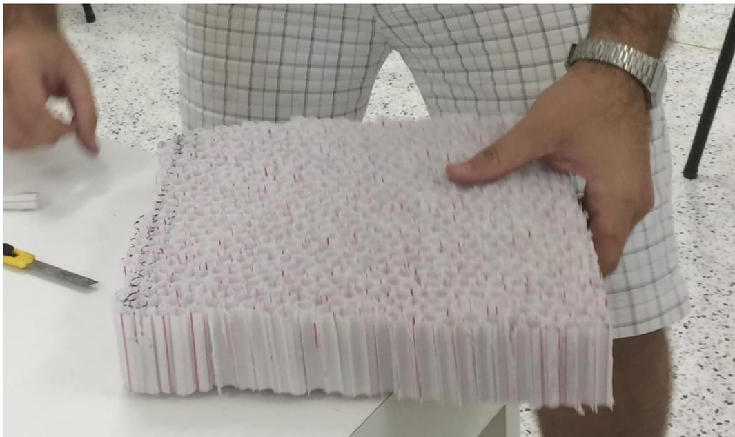
Figura 13 - Colmeia para estabilização do fluxo de ar, passando de turbulento para laminar. Reprodução própria. 2014.
