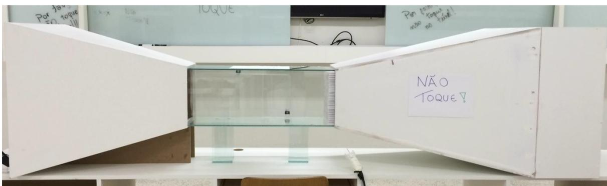
Figura 14 - Montagem final. Túnel de Vento Subsônico de Circuito Aberto. Reprodução Própria. 2014.
